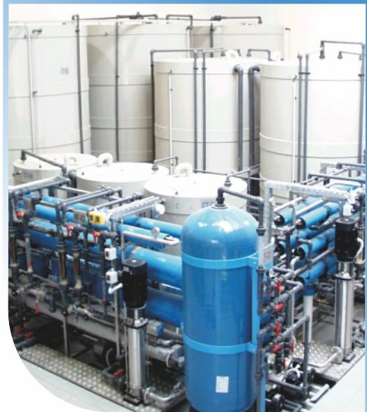
تصميم وإنتاج وتركيب محطة تنقية مياه الصرف الصحي المتنقلة في حاويات لمعالجة مياه الصرف الصحي الناجمة عن عمليات الجلفنة.
