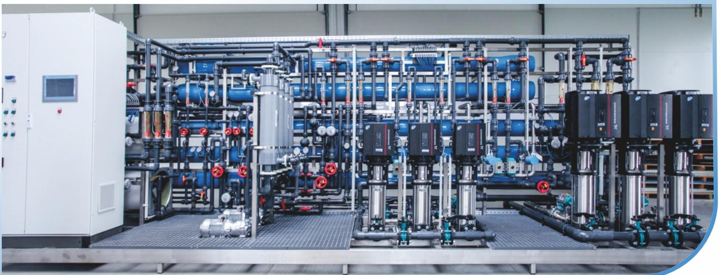
Construcción completa de un sistema de producción de agua de proceso desmineralizada a partir de agua superficial pretratada para su uso en una central eléctrica.
