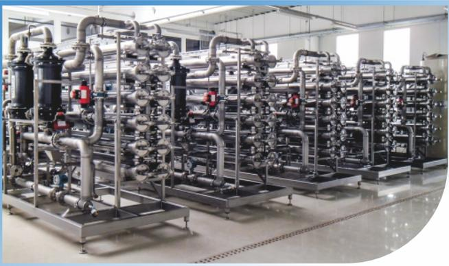
Sistema de producción de agua de proceso desmineralizada a partir de agua de río para una central nuclear.
