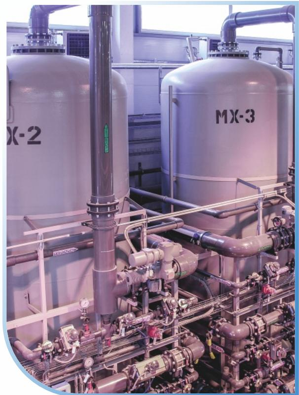
Sistema de espesamiento de lodo de cal con prensado de lodo para una planta química
