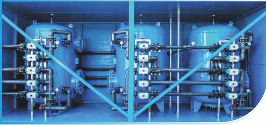
Diseño, fabricación y puesta en marcha de un sistema móvil de tratamiento de aguas residuales galvánicas, instalado en un contenedor.
