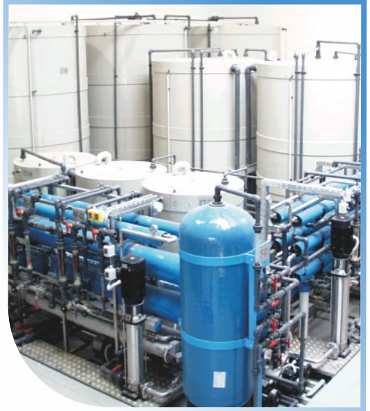
Rening och återvinning av avloppsvatten från tillverkning av flygplansdelar med ZLD-teknik. GE Aviation Hungary Ltd. / Ungern 100 m 3 /dag
